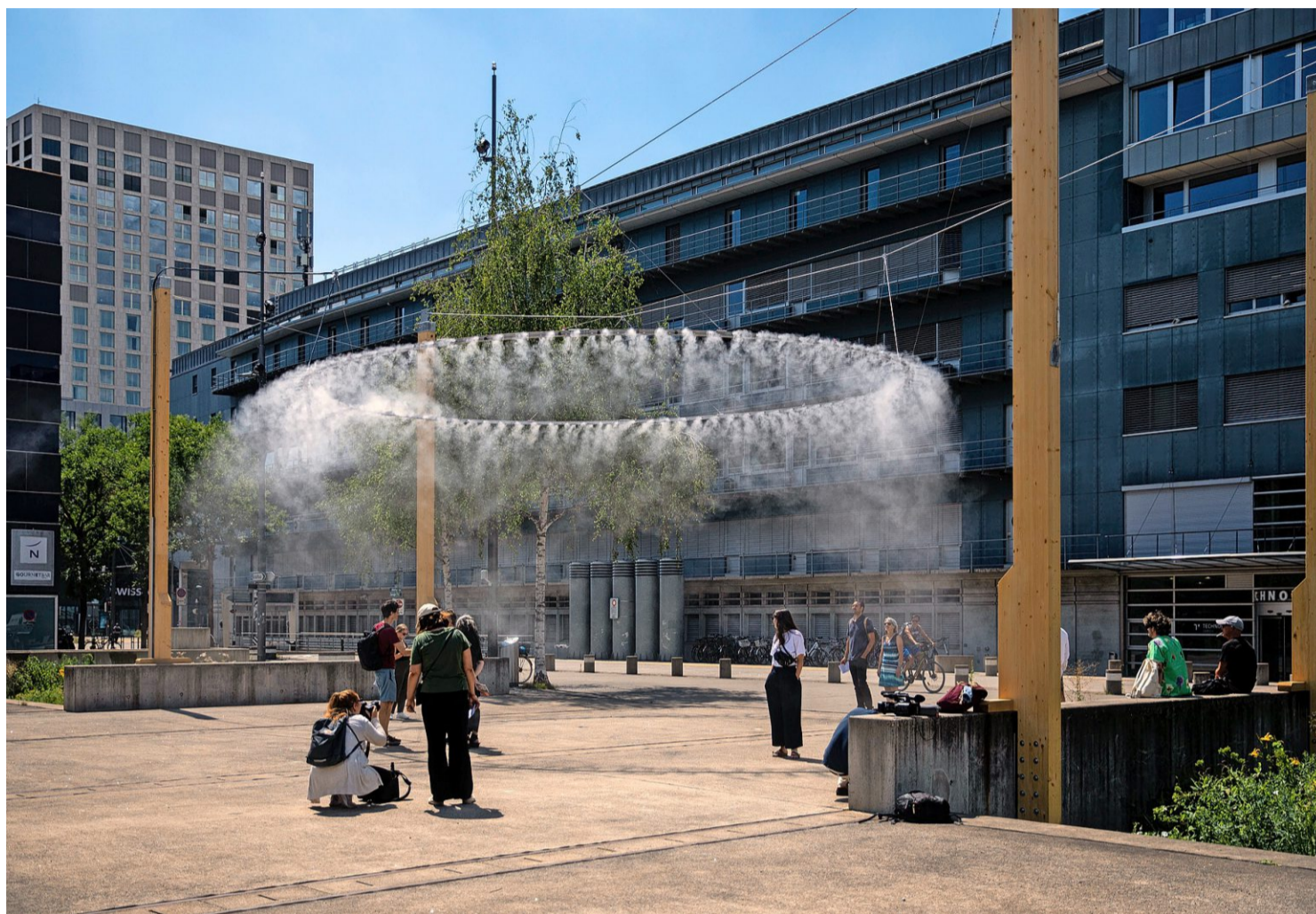
7,5 Liter Wasser zerstäubt der Aluminiumring pro Minute: Die künstliche Nebelwolke auf dem Turbinenplatz. Foto: Sabina Bobst
